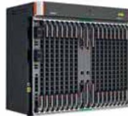
OLT Carrier Class modular GPON, 16 ranuras de servicio, 1 tarjeta de servicio, crecimiento hasta 256 puertos GPON o 128 XGPON
