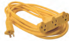
De uso rudo con 3 tomas tipo abanico de 127 Vca 50/ 60 Hz (L-N-T) 13 A.
