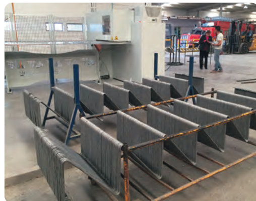
Doblado de "Z" por control numérico
