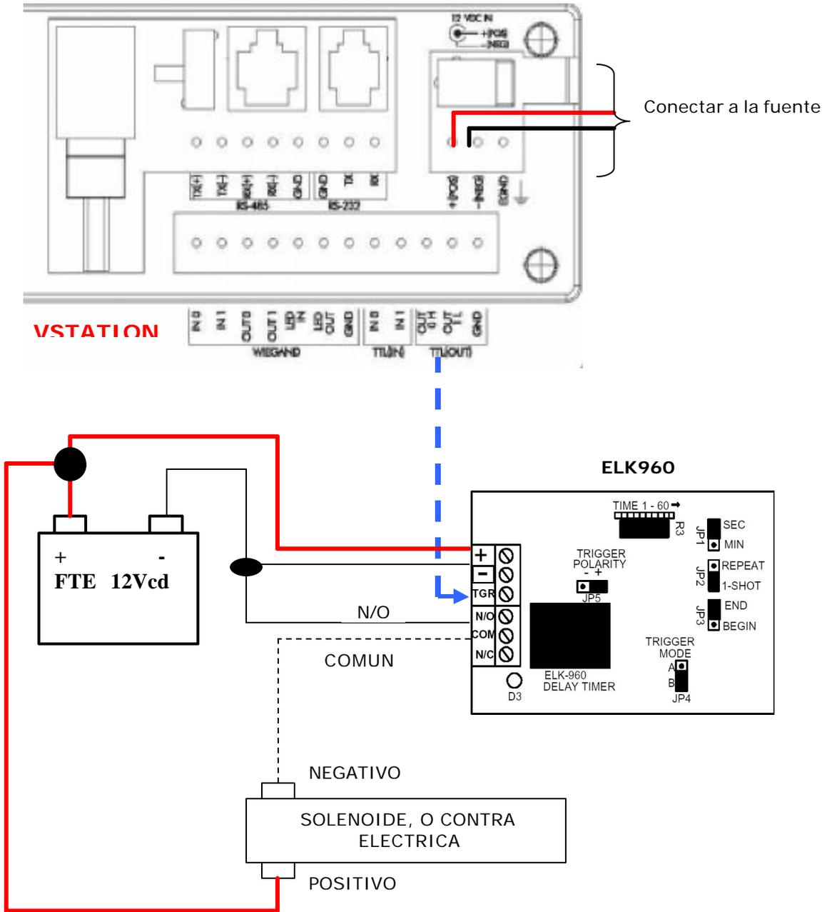
Instalacion utilizando la salida logica(de 0 a 5 Vcd) de la lectora Vstation directo a la entrada de triger (TGR)del modulo de relevador ELK960 Si utiliza Chapa Magnetica solo cambie el cable de N/O a la posicion de N/C.
