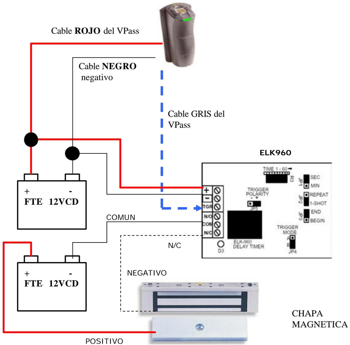
Instalacion utilizando la salida de Triger(de 0 a 5 Vcd) de la lectora VPass directo a la entrada de triger (TGR)del modulo de relevador ELK960. Si utiliza Contrachapa Electrica solo cambie el cable de N/C a la posicion de N/O.
